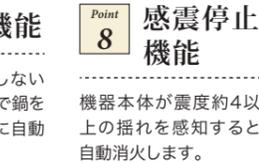
鍋を置いていない時は点火しない安心設計。点火している状態で鍋を離すと弱火になり、約1分後に自動消火します。
